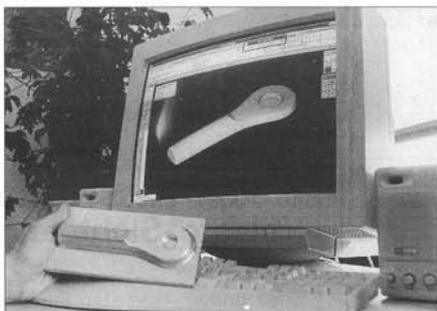
Virtual Development by MK-CAD, hier für die Ammann & Söhne AG: Die Idee des Kunden wird auf dem Computer dreidimensional umgesetzt. Anschliessend wird ein Prototyp gefertigt (links).
